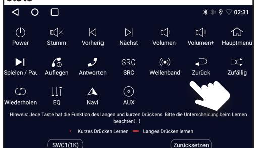
**Hinweis: Jedes Lenkradbedienelement kann entweder mit kurzem oder langem Druck betätigt werden.**
