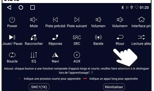
**N.B. Chaque commande sur le volant peut être utilisée soit avec une pression courte, soit avec une pression longue.**
